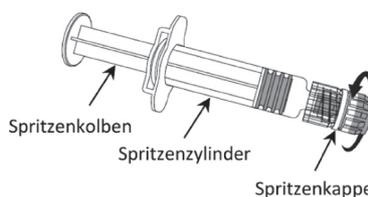
2. Um die Nadel an der Spritze anzubringen, drehen Sie die Nadel im Uhrzeigersinn in die Spritze bis sie fest sitzt (siehe Bild).
