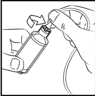
9. Schließen Sie die Infusionsleitung an den neuen CronoBell-Sleeve (mit der Patrone darin) an.
