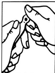
Abb. 1 Unterhalb des Punktes ist die Sollbruchstelle.
